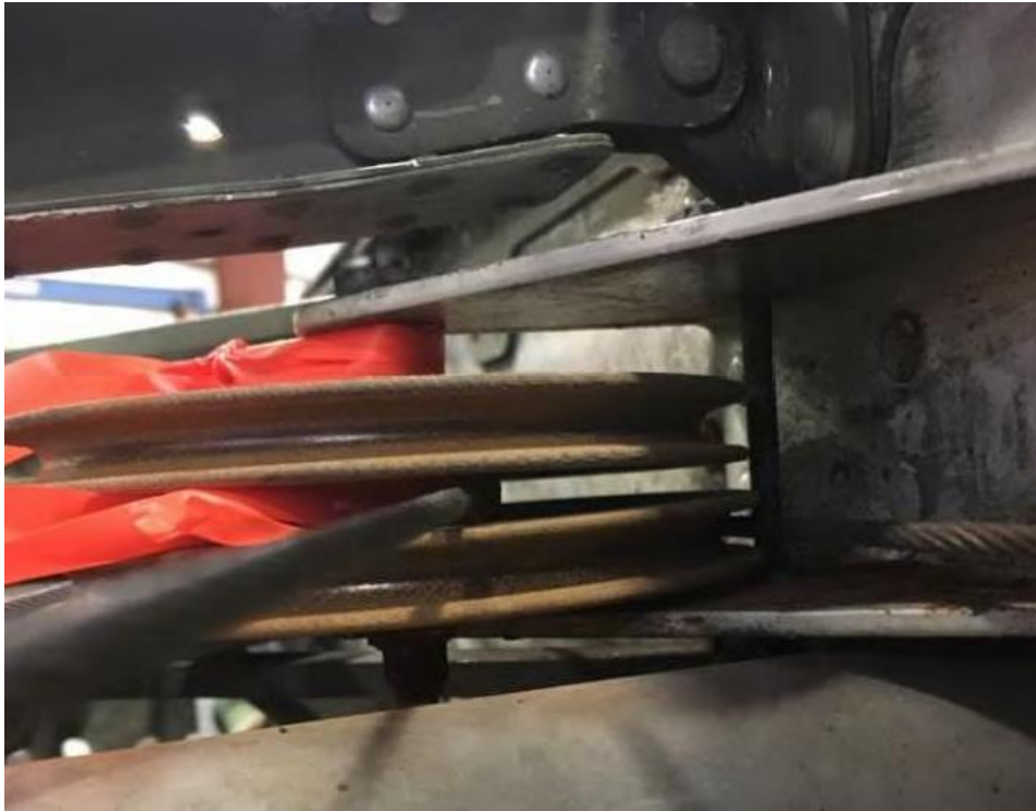
Câble de commande d'ailerons glissant entre deux poulies
