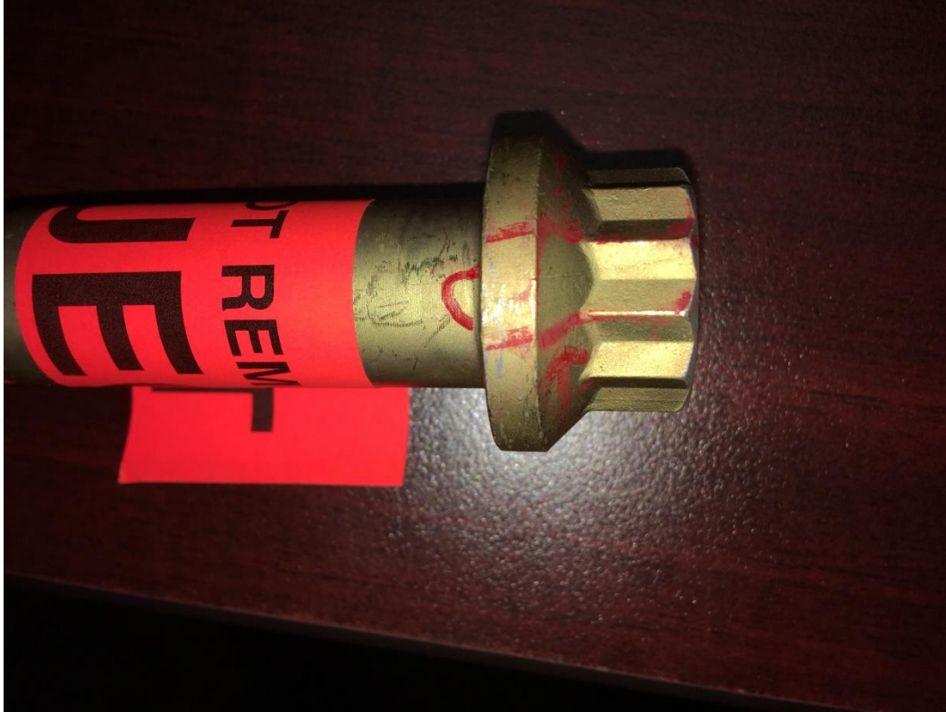
Figure 1. Boulon MS21250 12032 montrant la zone où la fissure a été détectée
