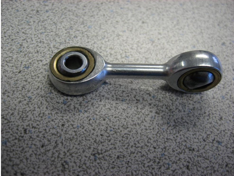
Figure 1 : Tringle de commande du papillon de réf. B564-2 avant l'incorporation du BS-71 sur le R44 comportant des chemins de roulement en bronze d'aluminium.
