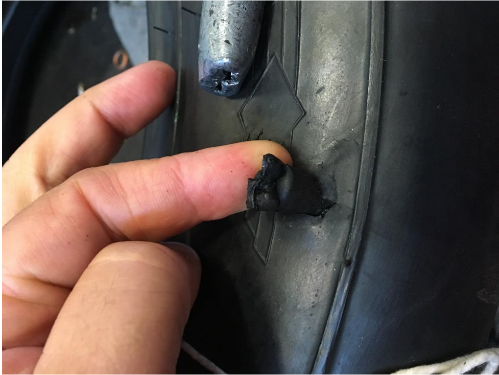
Fig. 3 : Indices que la pièce de métal a été moulée dans le pneu
