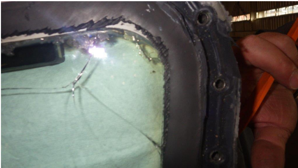
Figure 2. Fissure près du bornier et joint d'étanchéité érodé.
