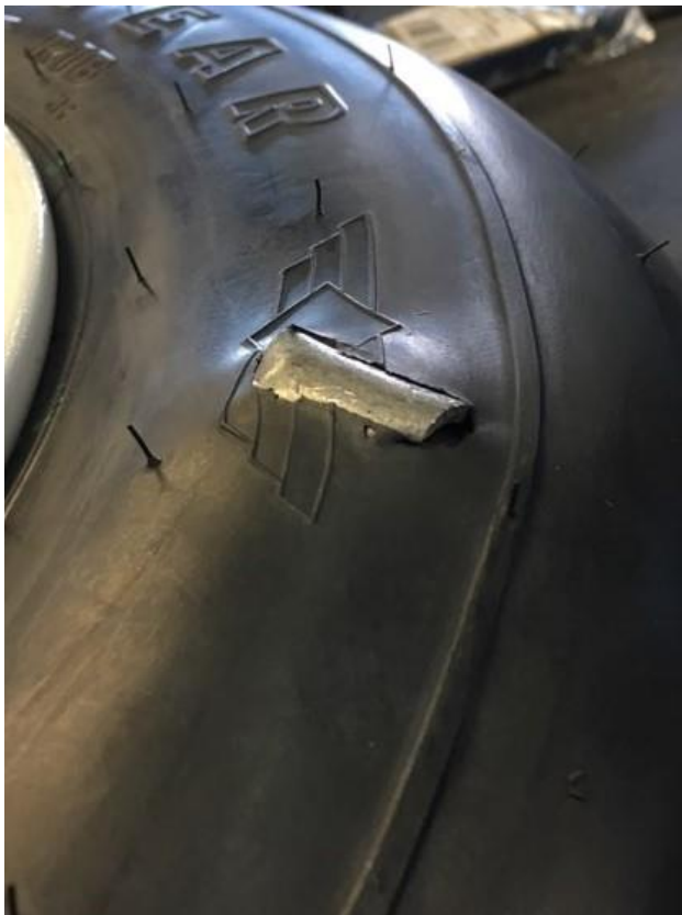
Fig. 2 : Pièce de métal qui dépasse
