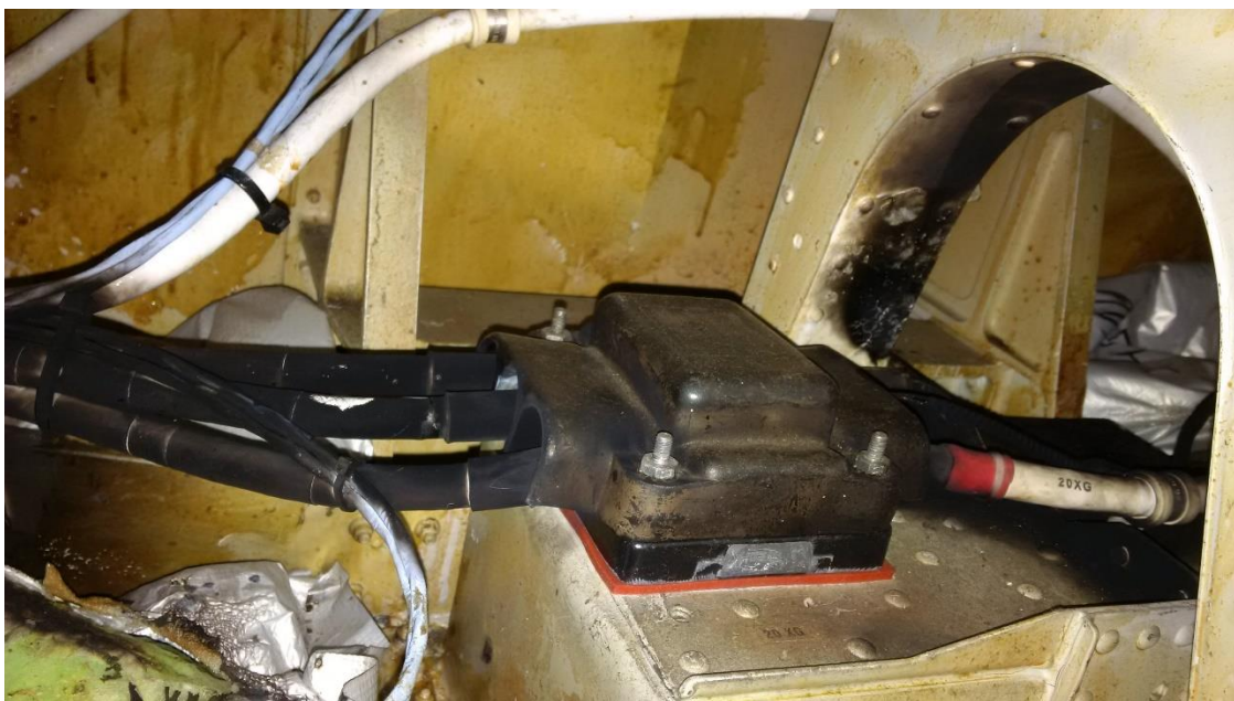
Photo 2 : Couverture commune de la prise.
